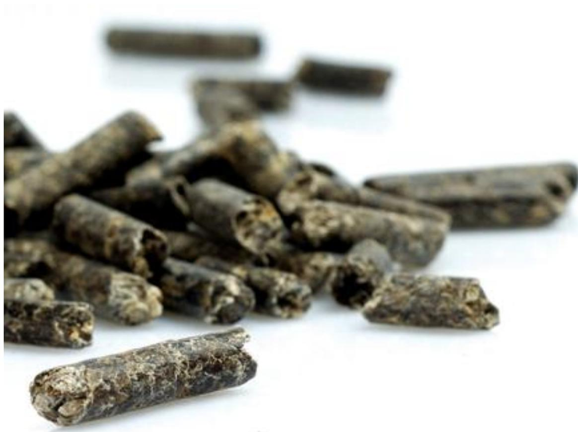
**Capdéa déshydrate de la pulpe de betterave et la réduit en bouchons de 6 mm de diamètre.**
